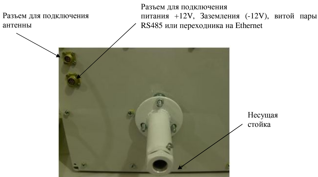
Рисунок 2. Несущая стойка и разъемы для подключения антенны, питания, заземления и витой пары
